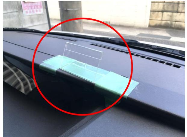
ダッシュボード上に卓上ネームプレートが貼付けできたら、続いて、前方カメラと運転手カメラを卓上ネームプレートに取り付けます。その際、カメラの上下向きに注意しながら、前方カメラは前向きに、運転手カメラは内向きにバチ型クリップを使って挟み止めます。
